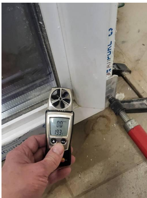
Фото 3, 4. Проверка подвижности воздуха около стыков соединения штапиков при испытаний на воздухопроницаемость при перепаде давления 500 Па (показатель 0,0 м/с).
