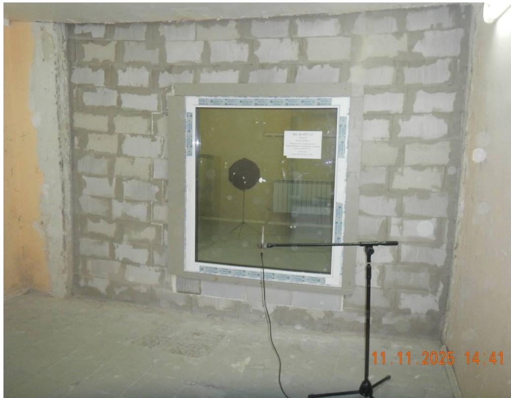
Фото 10. Испытание оконного блока регистрационный № 4977-25 в акустической камере, (камера низкого давления)
