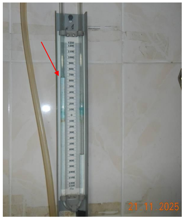
Фото 8, 9. Испытание образца (рег. № 4977-25) на водопроницаемость, не обнаружено сквозного проникновения воды через образец при перепаде давления 700 Па.
