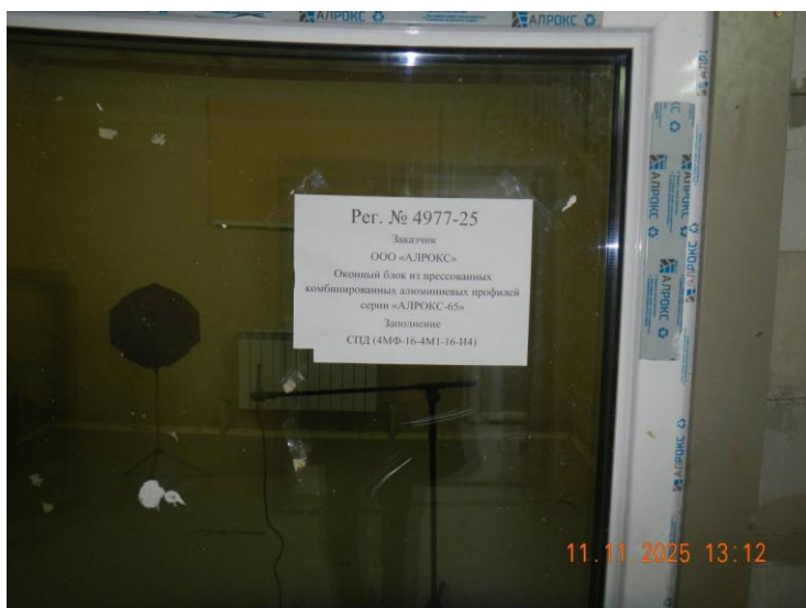
Фото 11. Испытание оконного блока регистрационный № 4977-25 в акустической камере, (камера высокого давления)
