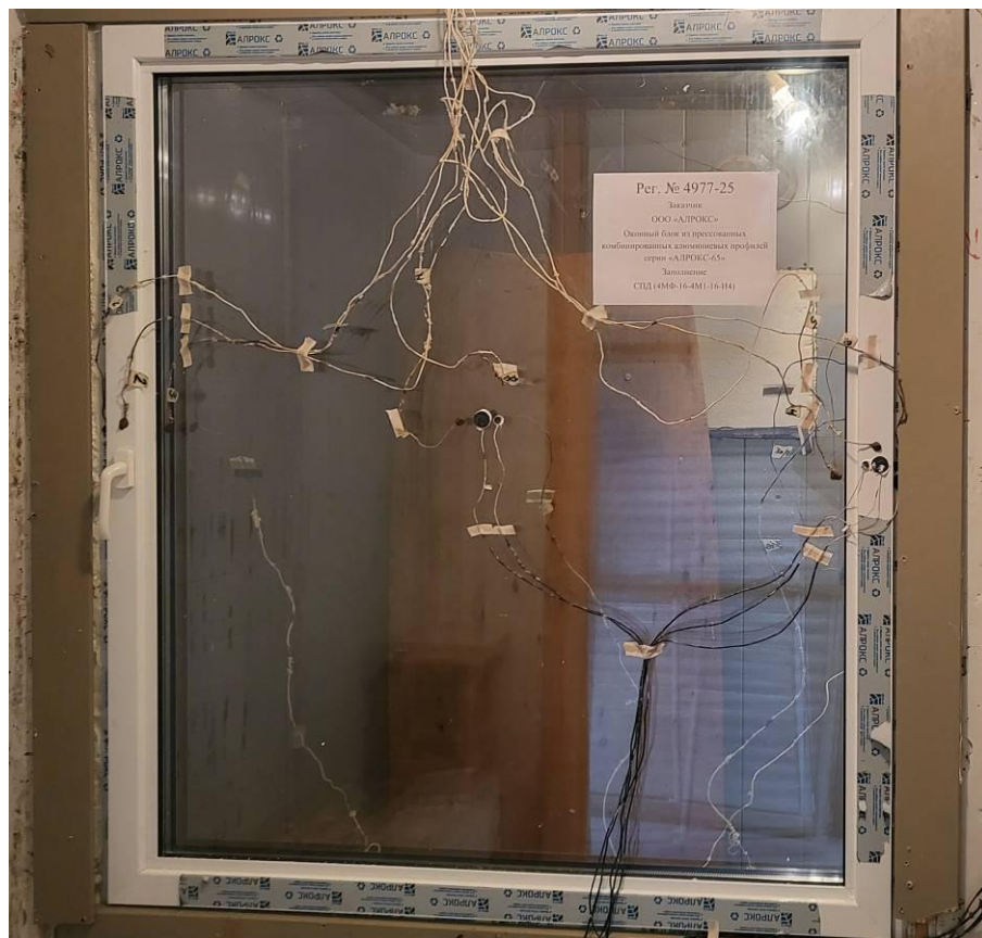
Фото 1. Оконный блок № 4977-25 в климатической камере (теплая сторона)
