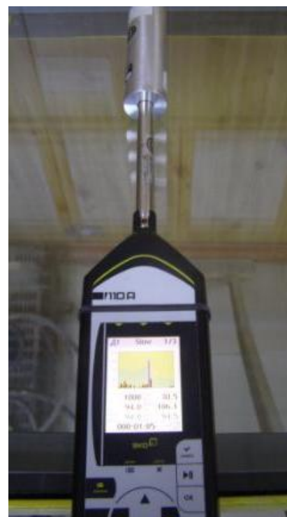
Фото 12. Калибровка шумомера при помощи калибратора акустического типа АК-1000, (калибровка аппаратуры проводилась до и после проведения измерения)
