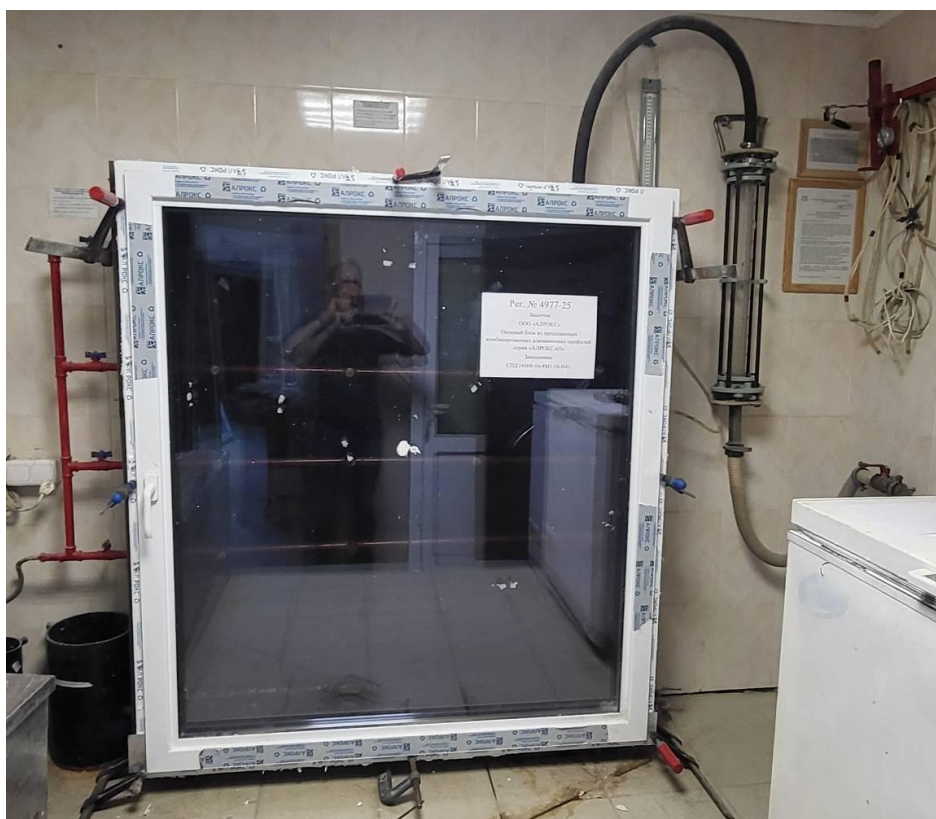
Фото 2. Испытание образца (рег. № 4977-25) на воздухопроницаемость
