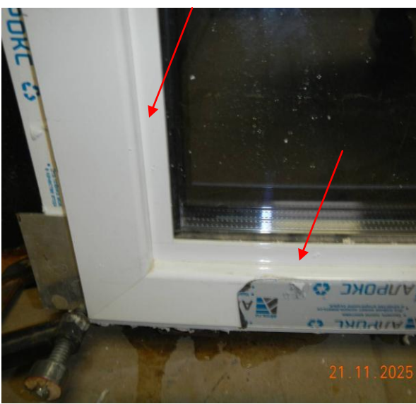
Фото 8, 9. Испытание образца (рег. № 4977-25) на водопроницаемость, не обнаружено сквозного проникновения воды через образец при перепаде давления 700 Па.
