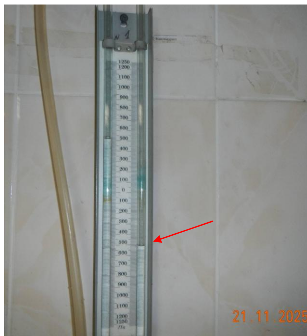
Фото 3, 4. Проверка подвижности воздуха около стыков соединения штапиков при испытаний на воздухопроницаемость при перепаде давления 500 Па (показатель 0,0 м/с).
