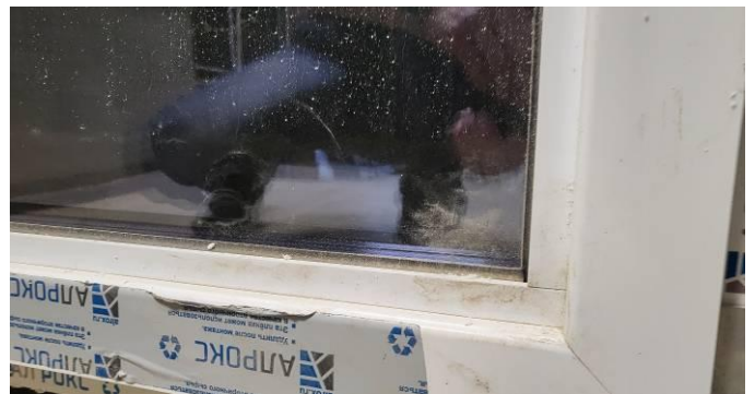
Фото 5, 6, 7. Испытание образца (рег. № 4977-25) на водопроницаемость.
