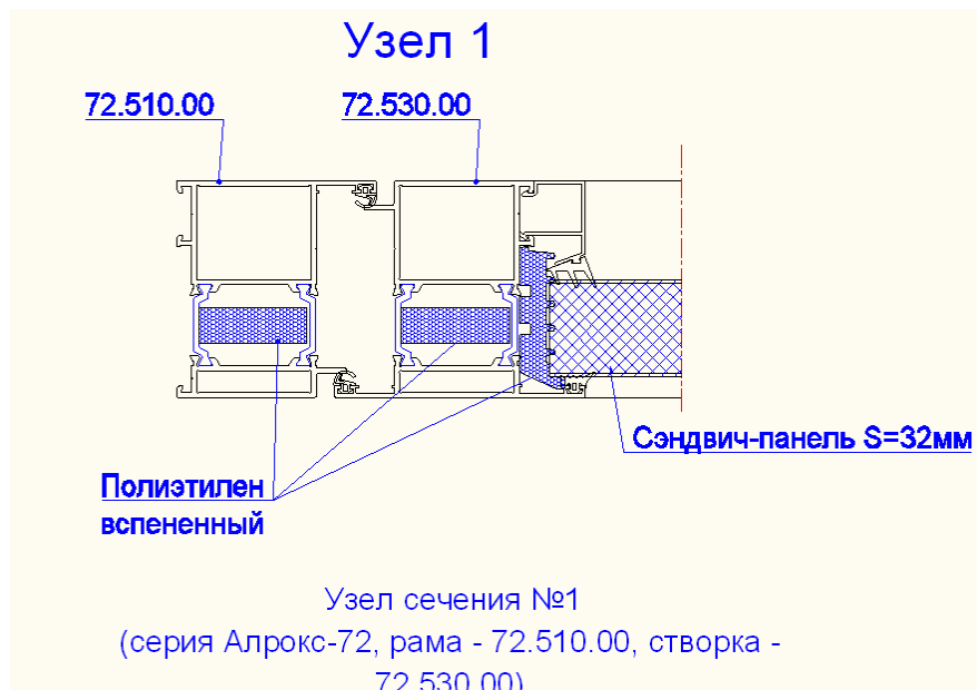
Рис. 1. Узел сечения №1, серия Алрокс-72, рама – 72.510.00, створка – 72.530.00
