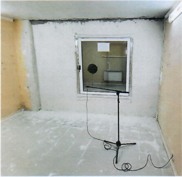
Фото 9, 10. Испытание оконного блока регистрационный № 4893-24 в акустической камере
