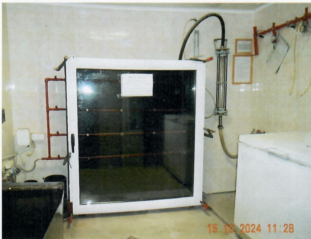
Фото 2. Испытание образца (рег. № 4893-24) на воздухопроницаемость
