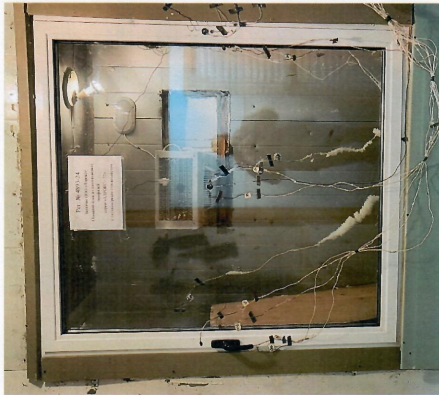
Фото 1. Оконный блок № 4893-24 в климатической камере (теплая сторона)
