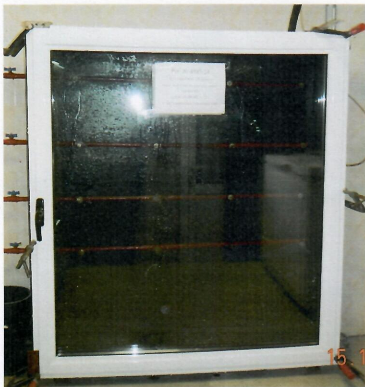
Фото 7, 8. Испытание образца (рег. № 4893-24) на водопроницаемость
