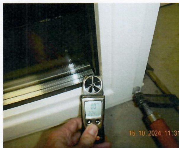
Фото 3, 4. Проверка подвижности воздуха около штапиков при испытаний на воздухопроницаемость при перепаде давления 200 Па (показатель 0 м/с).
