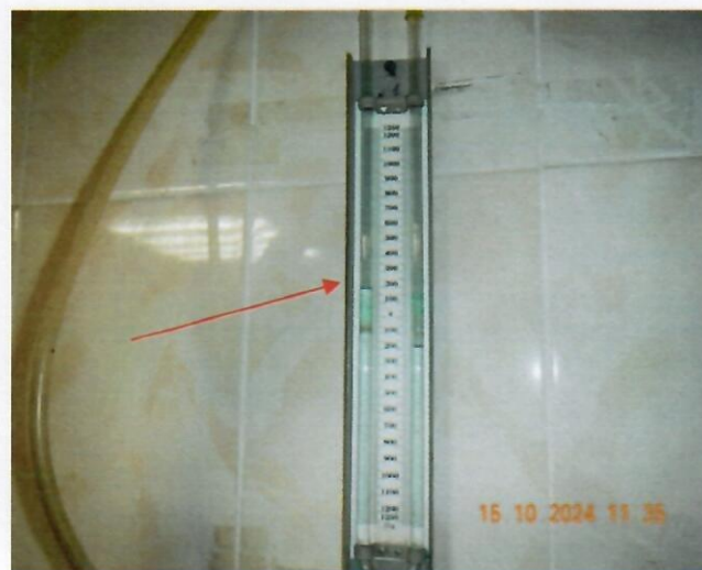
Фото 5, 6. Проверка подвижности воздуха в притворе при испытаниях на воздухопроницаемость при перепаде давления 200 Па (показатель 0 м/с).
