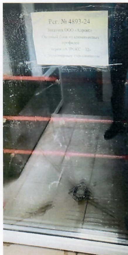
Фото 7, 8. Испытание образца (рег. № 4893-24) на водопроницаемость
