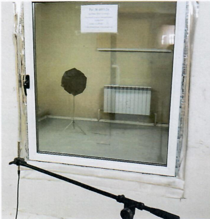
Фото 11. Испытание оконного блока регистрационный № 4893-24 в акустической камере
