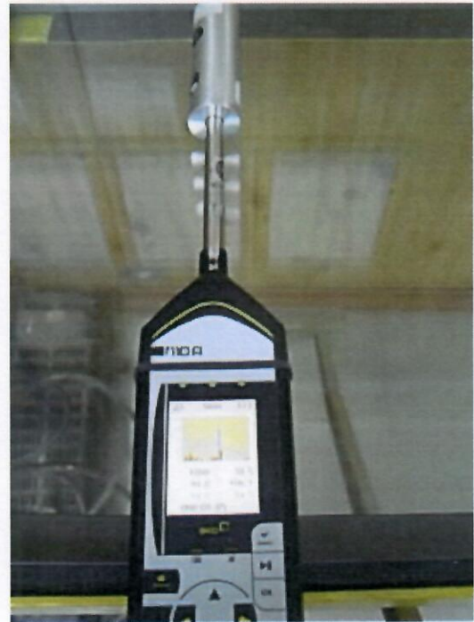
Фото 12. Калибровка шумомера при помощи калибратора акустического типа АК-1000, (калибровка аппаратуры проводилась до и после проведения измерения)
