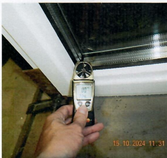
Фото 3, 4. Проверка подвижности воздуха около штапиков при испытаний на воздухопроницаемость при перепаде давления 200 Па (показатель 0 м/с).
