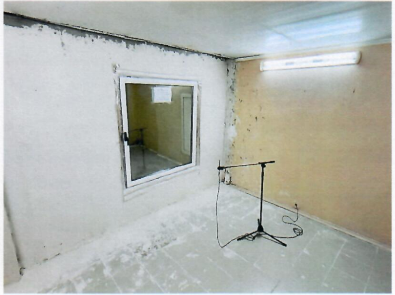
Фото 9, 10. Испытание оконного блока регистрационный № 4893-24 в акустической камере
