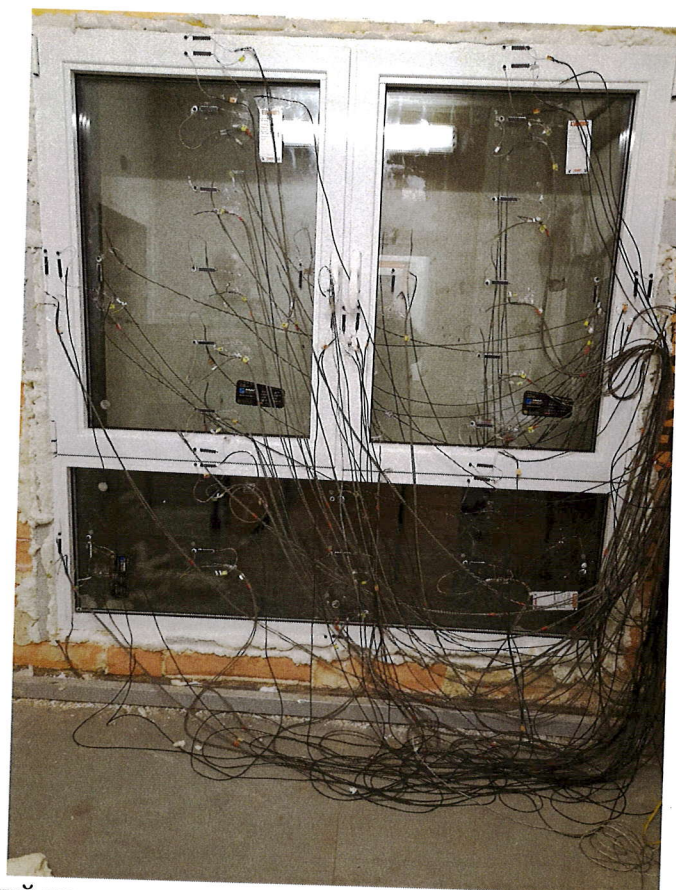
Рис.1. Схема расстановки датчиков температуры и теплового потока.
